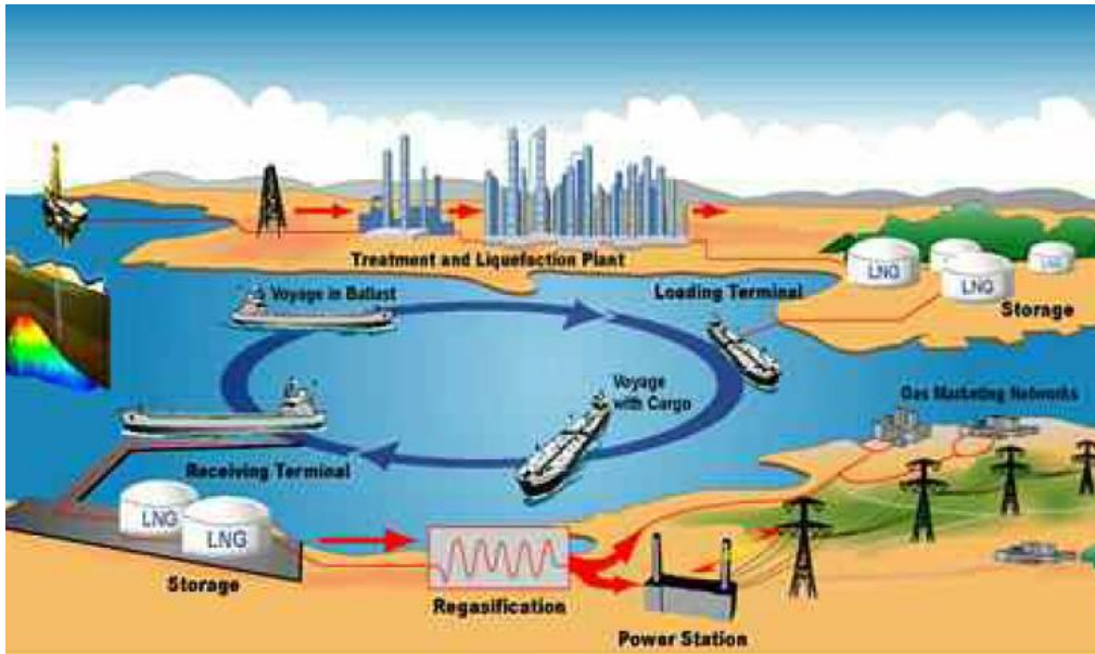
Εικόνα 5.1: Η αλυσίδα διάθεσης LNG, από την παραγωγή του, τη δια θαλάσσης μεταφορά του έως την παράδοση στον τελικό καταναλωτή Πηγή: (Coyle & Patel, 2005)
