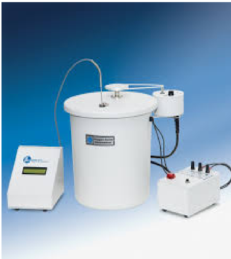
Εικόνα 23: Θερμιδόμετρο Parr 1341 που βρίσκεται στο εργαστήριο Προσομοίωσης Βιομηχανικών Διεργασιών στο Πανεπιστήμιο Πειραιά.
