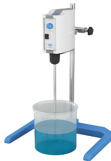
Εικόνα 26: Αναδευτήρας που χρησιμοποιείται στη προσομοίωση προσρόφησης.
