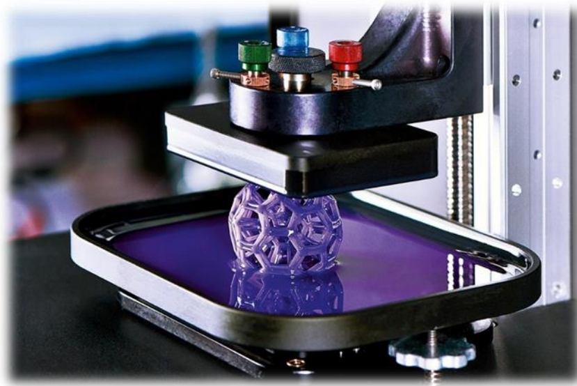
Εικόνα 2.1 Σχηματισμός σφαιροειδούς δομής με πολυγωνικό δικτύωμα σε τρισδιάστατο εκτυπωτή
