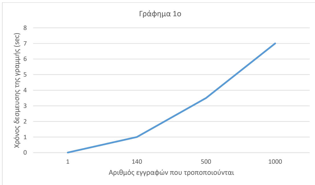
Γράφημα 1ο. Αναλογία φόρτου δικτύου και αριθμού τροποποίησης των εγγραφών για την γραμμή των 2Mbps
