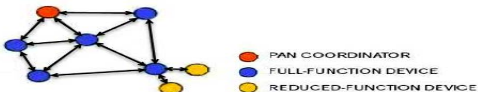
Σχήμα 2.2.2: Τοπολογία peer-to-peer. [Πηγή: Ergen S.C., (2004), ZigBee/IEEE 802.15.4 Summary]
