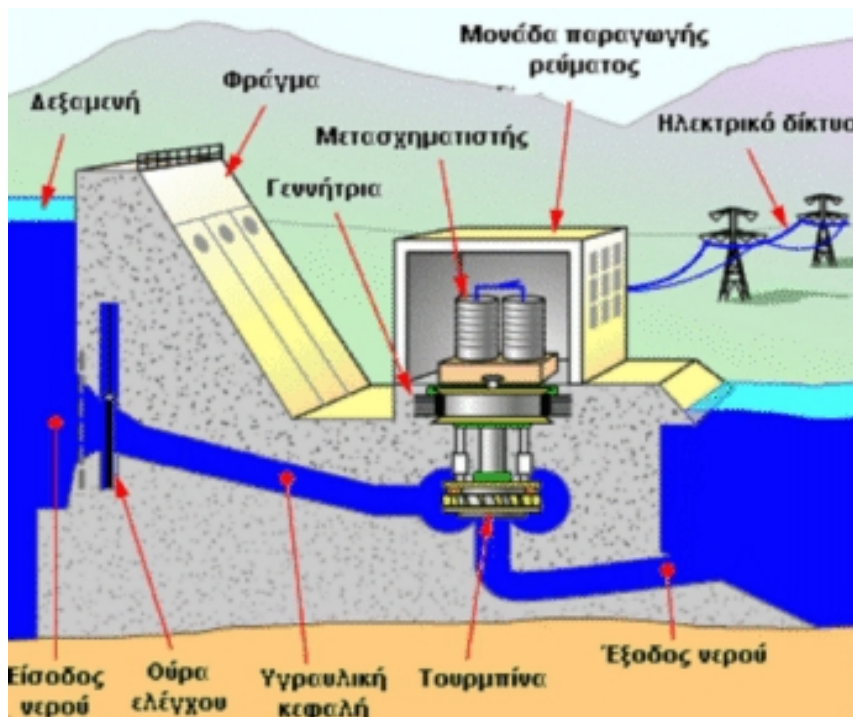
Εικόνα 4.2: Σύγχρονη διάταξη έργου παραγωγής υδροηλεκτρικής ενέργειας
