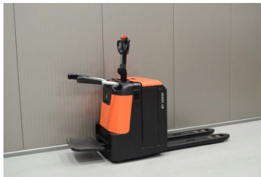
Εικόνα 4: Ηλεκτροφόρο παλετοφόρο εποχούμενου χειριστή
