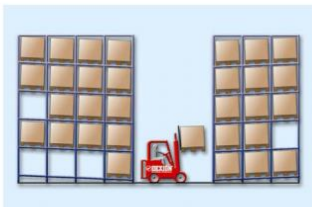
Εικόνα 5 Σύστημα ραφιών push-back
