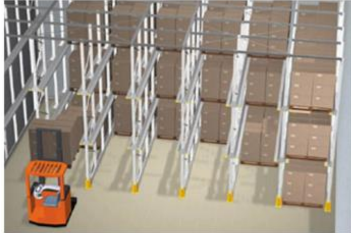
Εικόνα 4 Σύστημα ραφιών drive-in
