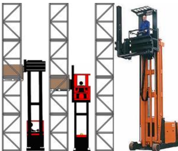
Εικόνα 13 Περονοφόρο ανυψωτικό VNA truck
