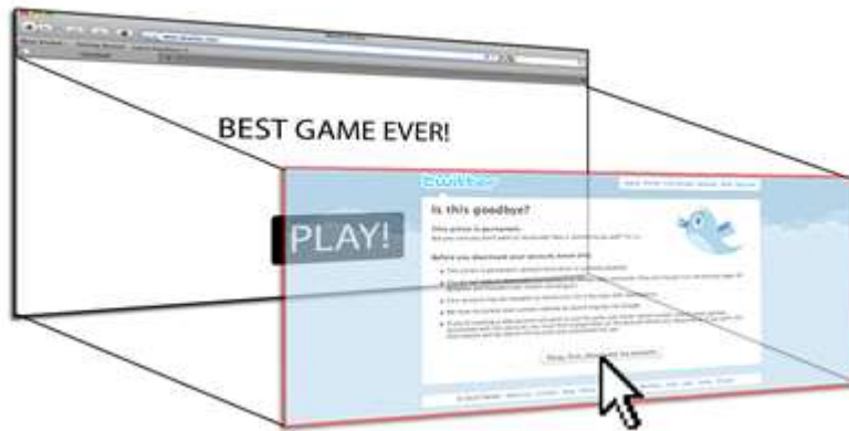
Εικόνα 5: Σχηματική απεικόνιση Clickjacking Attack. Το κρυφό αντικείμενο δε φαίνεται στον επισκέπτη.
