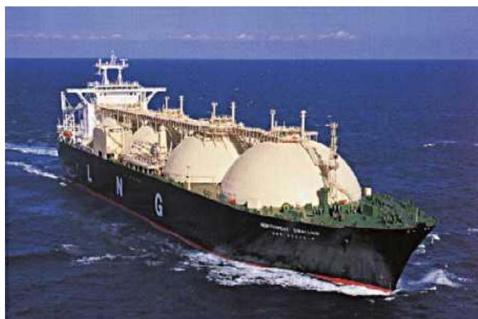
Εικόνα 3.4 Δεξαμενόπλοιο LNG τύπου Moss Rosenberg με τις χαρακτηριστικές σφαιρικές δεξαμενές
