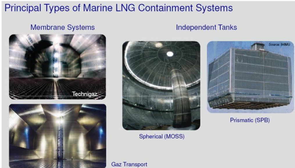
Εικόνα 3.8 Οι Βασικοί Τύποι Συστημάτων δεξαμενών πλοίων μεταφοράς LNG
