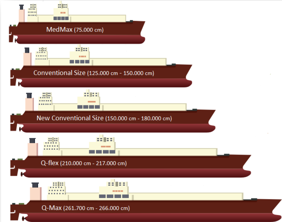
Εικόνα 3.1 Κατηγορίες Δεξαμενόπλοιων μεταφοράς Υγροποιημένου Φυσικού αερίου
