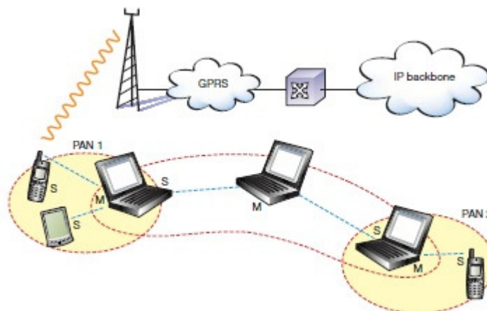
Σχήμα 4.4 Scatternet- based PANs μέσω GPRS / UMTS
