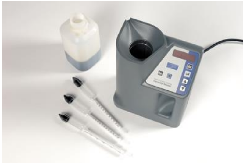
Εικόνα 4.2. Συσκευή τοποθέτησης δείγματος προς θερμοστάτηση και μέτρηση πυκνότητας με υδρόμετρα.
