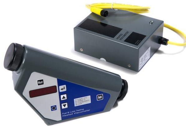
Εικόνα 4.3. Συσσκευή αυτόματης μέτρησης κινηματικού ιξώδους.
