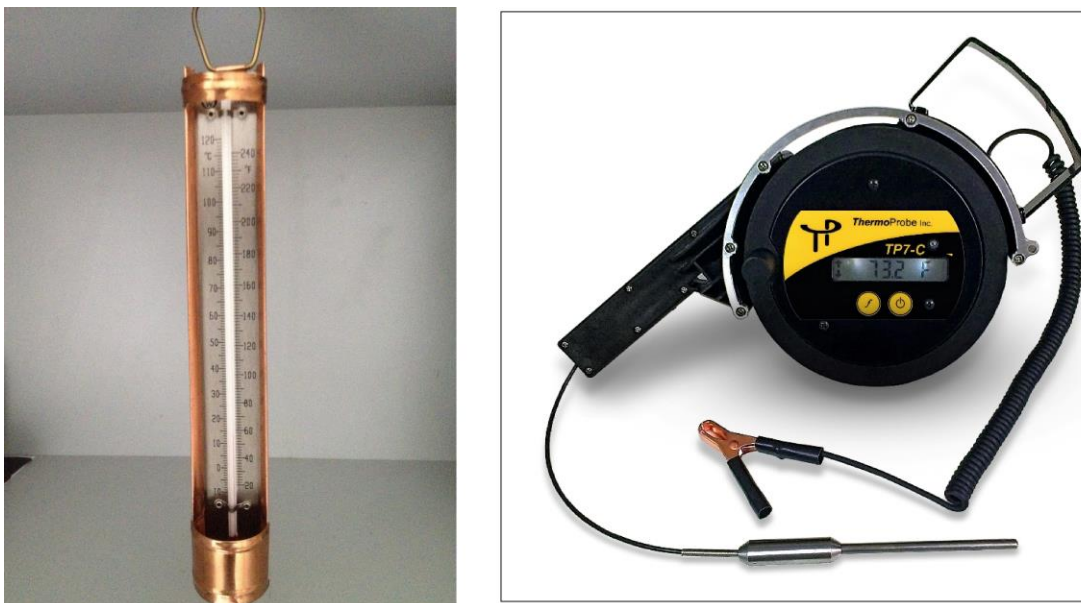
Εικόνα 2.12. : Φωτογραφία υδραργυρικού θερμομέτρου στα αριστερά και ηλεκτρονικού θερμομέτρου με άγκιστρο γείωσης στα δεξιά.
