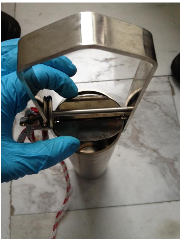
Εικόνα 2.19. Δειγματολήπτης Zone Sampler με το άνω μέρος του (έξοδος) να απεικονίζεται στα αριστερά και το κάτω μέρος του (είσοδος) στα δεξιά.
