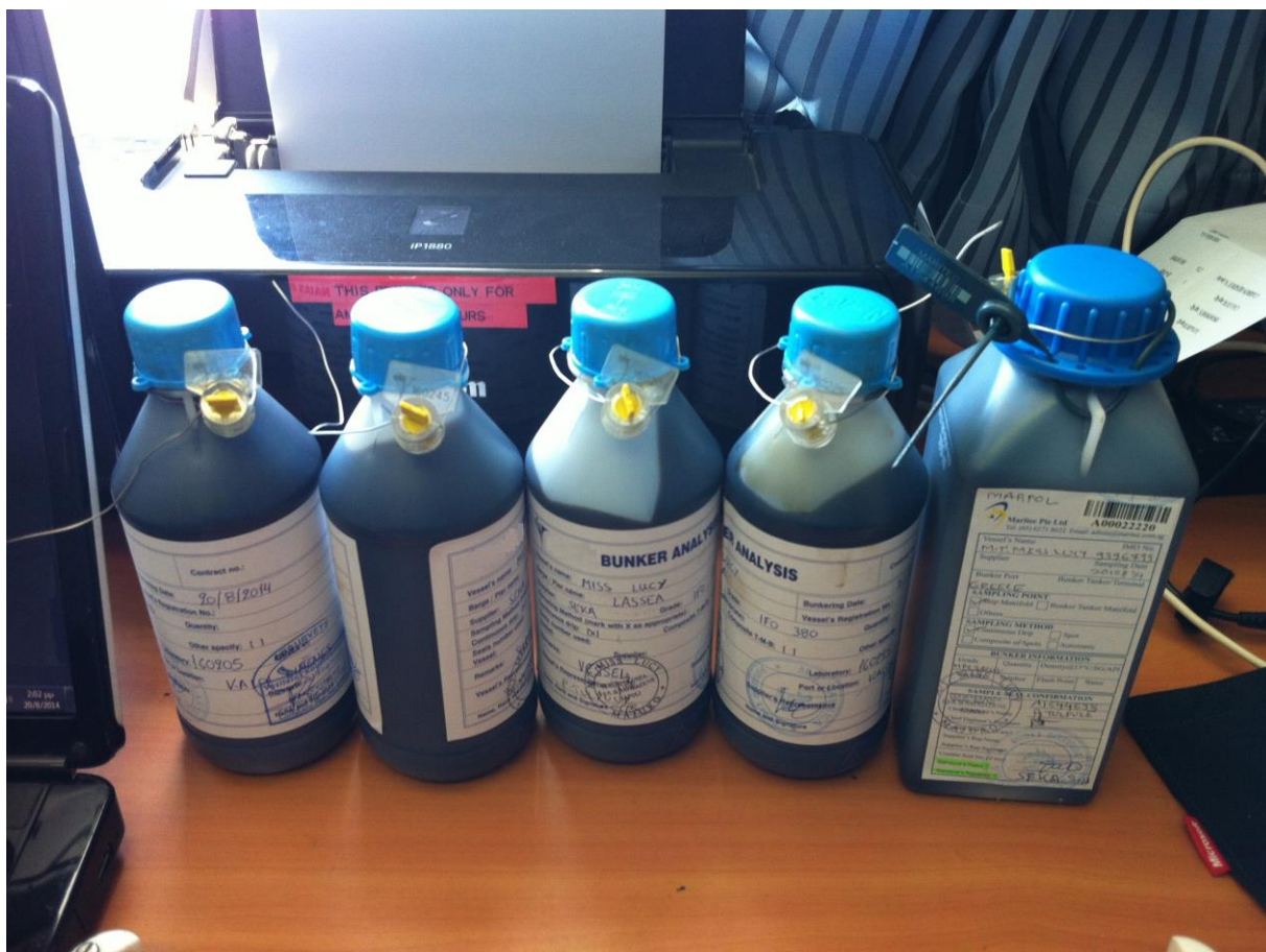
Εικόνα 2.21. Φωτογραφία σειράς από έτοιμα σφραγισμένα δείγματα ενός Bunkering Operation λίγο πριν μοιραστούν στα συμβαλλόμενα μέρη.
