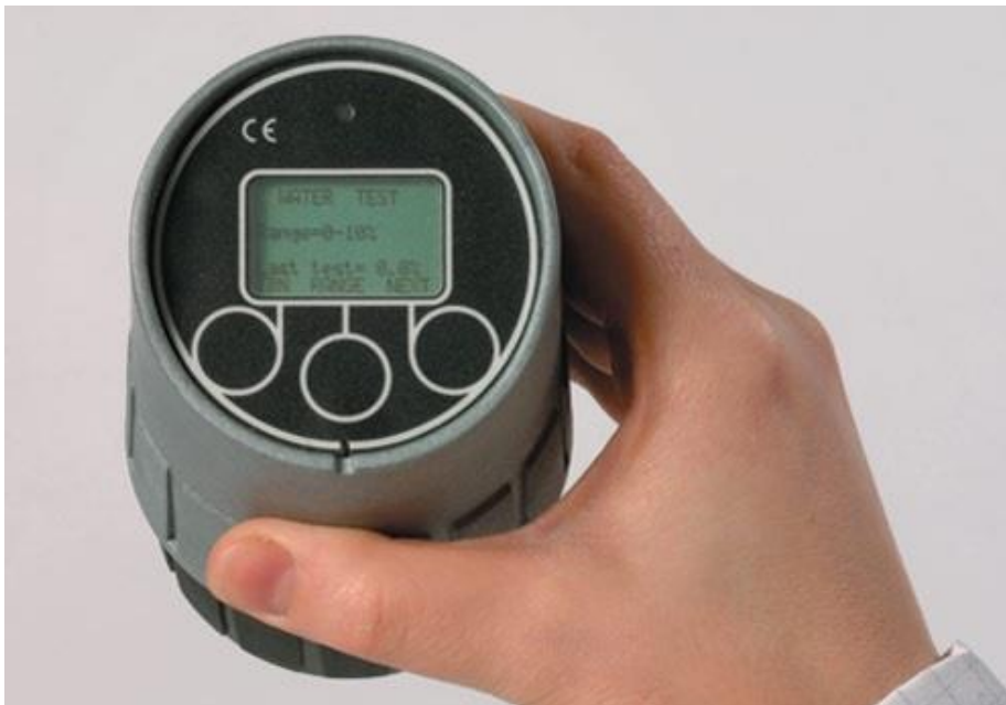
Εικόνα 4.9. Αυτόματη compact συσκευή μέτρησης περιεκτικότητας σε νερό
