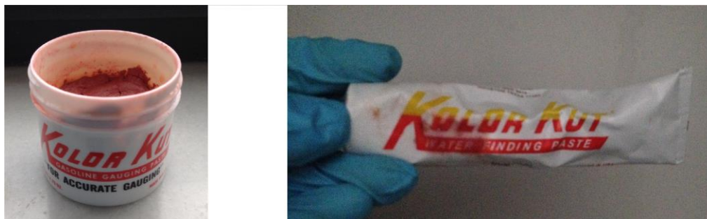
Εικόνα 2.10. : Αριστερά απεικονίζεται πάστα για ένδειξη στάθμης σε “καθαρά” προϊόντα πετρελαίου ενώ δεξιά η αντίστοιχη πάστα για εντοπισμό νερού.
