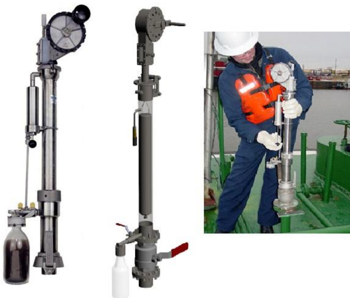
Εικόνα 2.20. Πραγματική φωτογραφία κλειστού δειγματολήπτη στα αριστερά. Σχέδιο Close Sampler με εσωτερική όψη στην μέση. Φωτογραφία δειγματοληψίας από Ullage point με ίδιο δειγματολήπτη πάνω σε πλοίο στα δεξιά.
