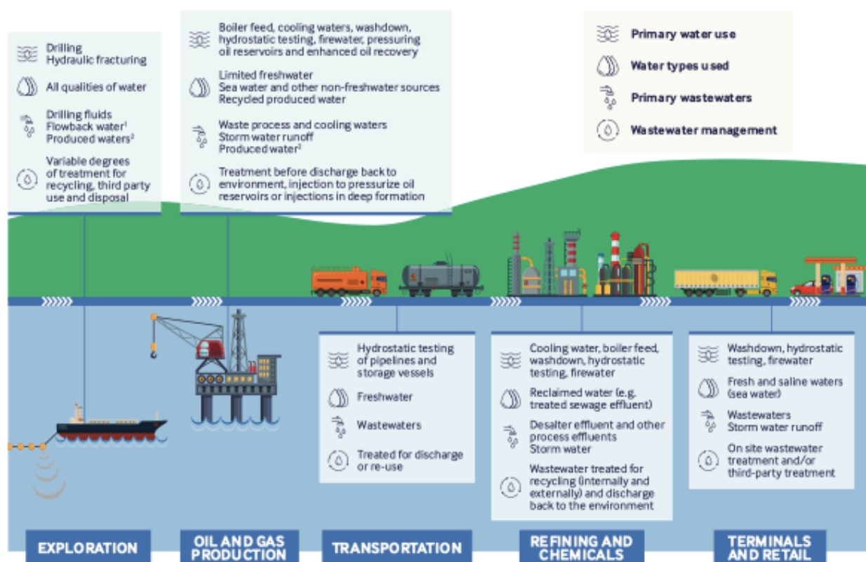
Εικόνα 3 - 2 Η χρήση του νερού κατά μήκος της αλυσίδας αξίας του πετρελαίου και του φυσικού αερίου (IPIECA, 2021)
