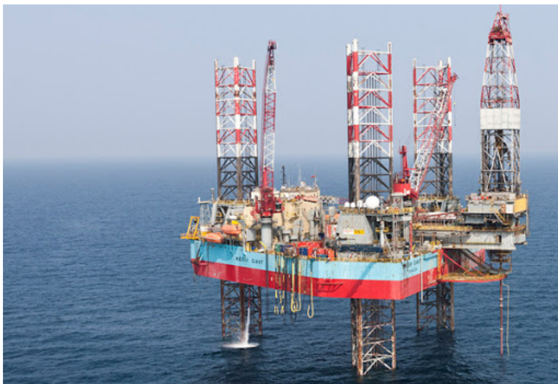
Εικόνα 1 - 6 Αυτοανυψούμενη εξέδρα (jack-up) (Offshore Fleet Journal, 2020)
