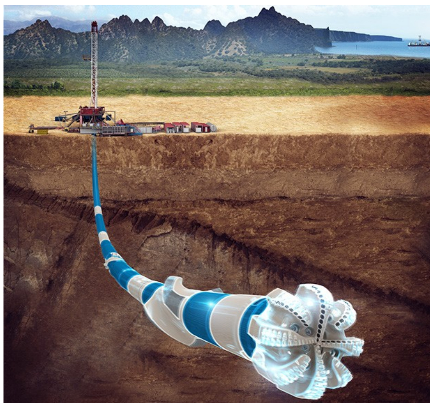
Εικόνα 1 - 4 Αναπαράσταση Directional Drilling (sealandws.com, 2020)
