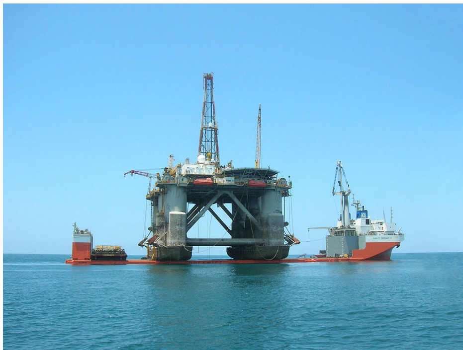
Εικόνα 1 - 9 Πλωτή ημιβυθιζόμενη εξέδρα (Wikipedia, 2020)
