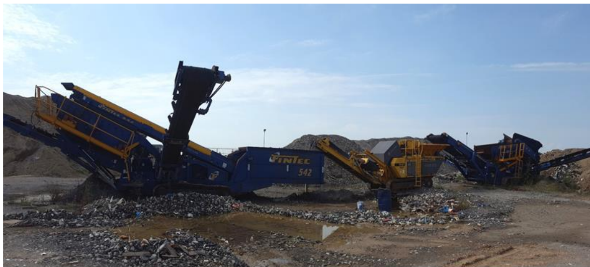
Εικόνα 4: Διάταξη φορητών μηχανημάτων επεξεργασίας Α.Ε.Κ.Κ. και αποθηκευμένα ανακυκλώσιμα (ΤΕΧΝΙΚΗ ΑΝΑΚΥΚΛΩΣΗΣ ΑΔΡΑΝΩΝ Α.Ε)
