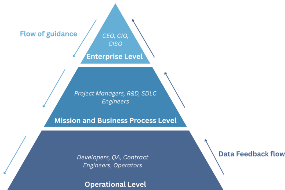
Σχήμα 2: Ιεραρχικά επίπεδα εφαρμογής της διαχείρισης κυβερνοκινδύνων στην αλυσίδα εφοδιασμού (C-SCRM)
