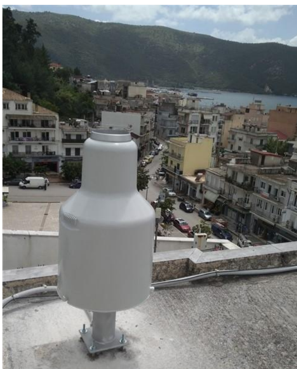
Εικόνα 2.3 Σύστημα έγκαιρης παρακολούθησης πλημμυρικών φαινομένων για την πόλη της Ηγουμενίτσας METRICA A.E, σε συνεργασία με το Πανεπιστήμιο Ιωαννίνων για λογαριασμό του Δήμου Ηγουμενίτσας
