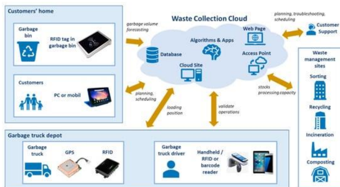
Εικόνα 4.2 Έξυπνο Σύστημα Διαχείρισης και Συλλογής Απορριμμάτων με Χρήση Τεχνολογιών Industry 4.0
