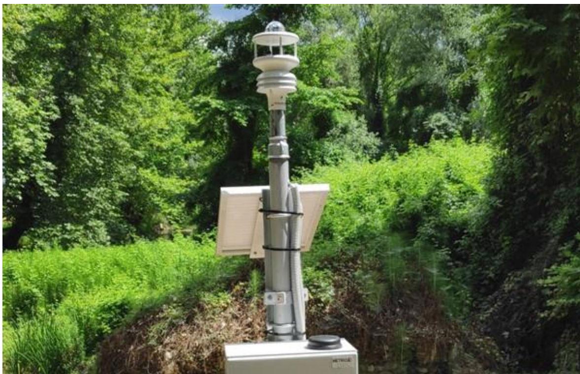
Εικόνα 2.2 Σύστημα έγκαιρης παρακολούθησης πλημμυρικών φαινομένων για το Αρχαιολογικό Πάρκο ΔΙΟΝ στην περιοχή του Ολύμπου της METRICA A.E, σε συνεργασία με το ΕΚΕΦΕ Δημόκριτος
