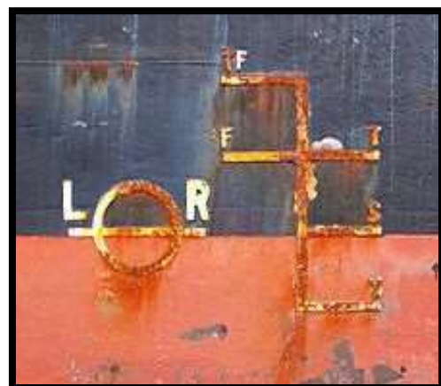
Εικόνα 2.2.2: Γραμμές φόρτωσης πάνω σε πλοίο
