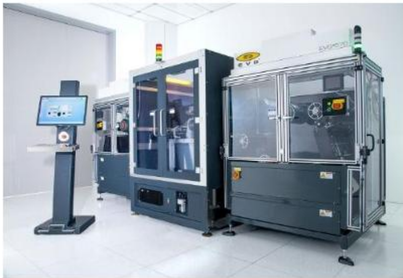
Εικόνα 3.10 Συσκευή νανολιθογραφίας για παραγωγή πλαστικών ηλεκτρονικών και φωτοβολταϊκών (azonano, 2013)
