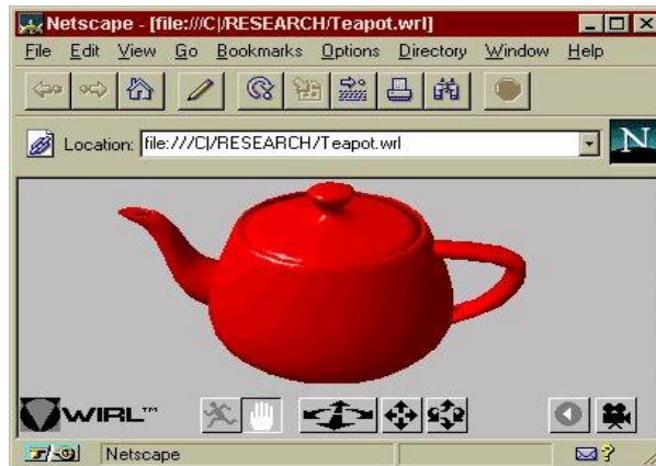
Εικόνα 2.4: Το τσαγιερό της Utah. Πρωτοκατασκευάστηκε στο πανεπιστήμιο της Γιούτα το 1975 από τον M.Newell. Το πολύ-γωνικό πλέγμα τσαγιερού έχει γίνει ένα σημαντικό στοιχείο στα κομπιούτερ γραφικών. Αυτή η εκδοχή του VRML περιέχει 1976 κορυφές και 3751 πολύγωνα.
