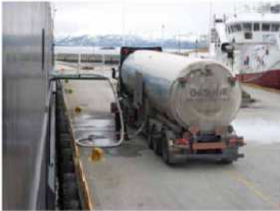
Εικόνα 9: Τροφοδοσία πλοίου με LNG από φορτηγό
