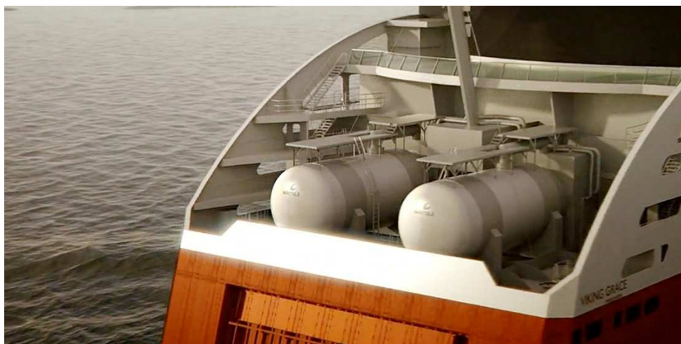
Εικόνα 14: Τοποθεσία των δεξαμενών στο πλοίο Viking Grace
