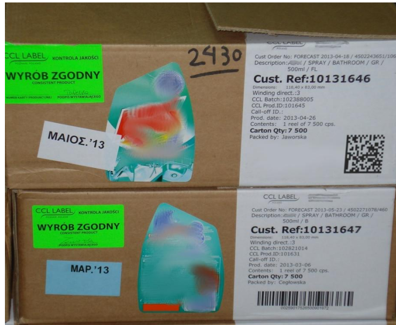
Εικόνα 3.2.1.2. Κιβώτια υλικών συσκευασίας, πάνω μετά τη χρήση του QR κώδικα, κάτω πριν τη ηλεκτρονική ιχνηλασιμότητα
