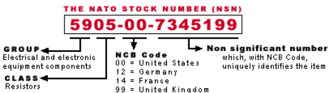
Εικόνα 8: Ο Ονομαστικός Αριθμός Αποθήκευσης NATO (NSN), αποτελείται από 13 ψηφία που συγκροτούνται από την ενοποίηση τριών διαφορετικών αριθμών. Τα 4 πρώτα από το NSC, τα επόμενα δυο από το NCB και τα τελευταία 7 μηχανογραφικά.
