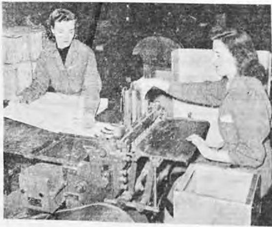
Εικόνα 3. Ἡ μηχανή αὐτή ἡ ὁποία κόπτει λεπτὸν χάρτην εἰς δεσμίδας ἐρεισμάτων διὰ τὰ κουτιά τῶν τοιγάρων εἶναι ἐφοδιασμένη μετὰ μηχανισμόν ὁ ὁποῖος αὐτομάτως τὰ στοιβάζει· προηγουμένως οἱ κομμένα δεσμίδες ἐπιπτον εἰς ὑποδοχεα, εὐρισκόμενον καὶ τῶθεν καὶ ἦτο ἀνάγκη νὰ στοιβάζονται μετὰ τὸ χερῖ.
