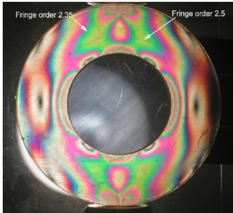
Φωτογραφία 5.5 Δακτύλιος υπό θλιπτικό φορτίο 500 Nt σε κυκλικό πολωροσκόπιο
