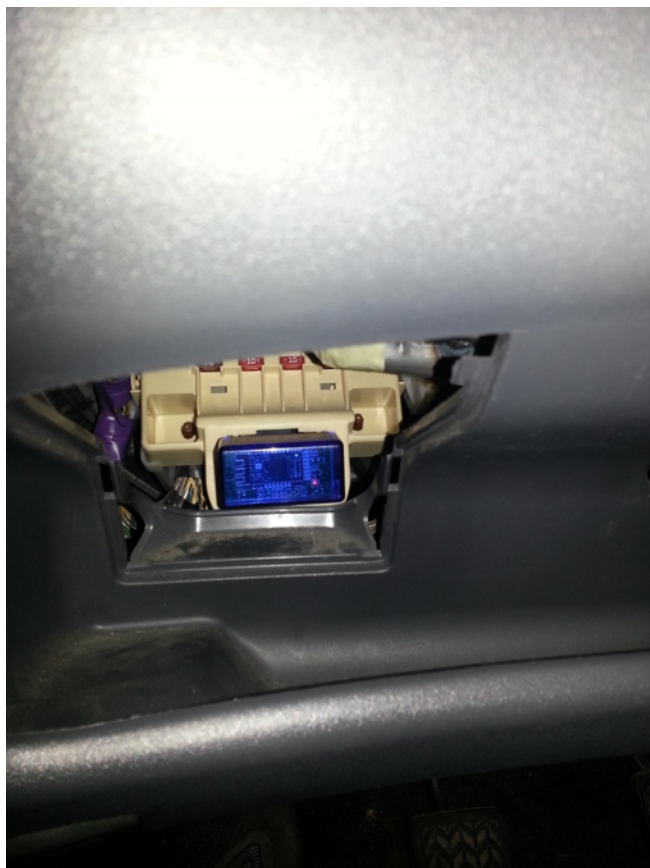
Εικόνα 2: Το ολοκληρωμένο σε σύνδεση με τη θύρα OBDII του οχήματος. Διακρίνεται το κόκκινο LED που σηματοδοτεί την ενεργοποίηση της συσκευής.
