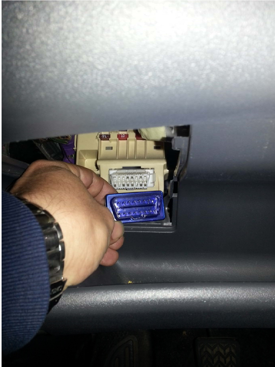
Εικόνα 1: Σύγκριση της θύρας του ολοκληρωμένου με αυτή του οχήματος. Η πάνω πλευρά των θυρών είναι πιο πλατιά από την κάτω προκειμένου να μην είναι εφικτή η λανθασμένη σύνδεση.
