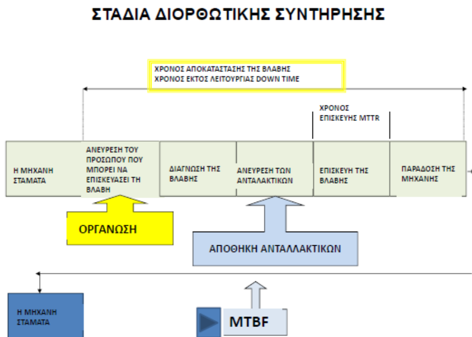
Σχήμα 1.3. Στάδια διορθωτικής συντήρησης.
