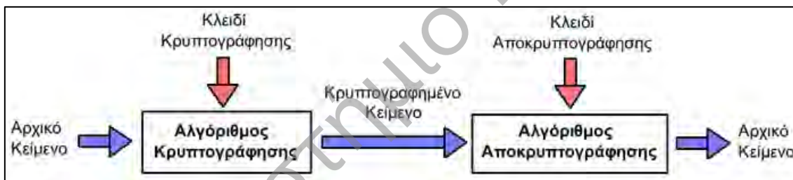
Εικόνα 41: «Τυπικό σύστημα κρυπτογράφησης – αποκρυπτογράφησης» πηγή εικόνας: http://en.wikipedia.org/wiki/Cryptography
