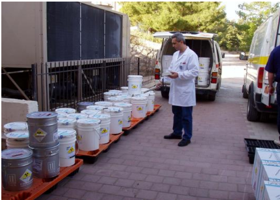
Εικόνα 18: Μέτρηση εκπομπής ραδιενέργειας πριν τη μεταφορά
