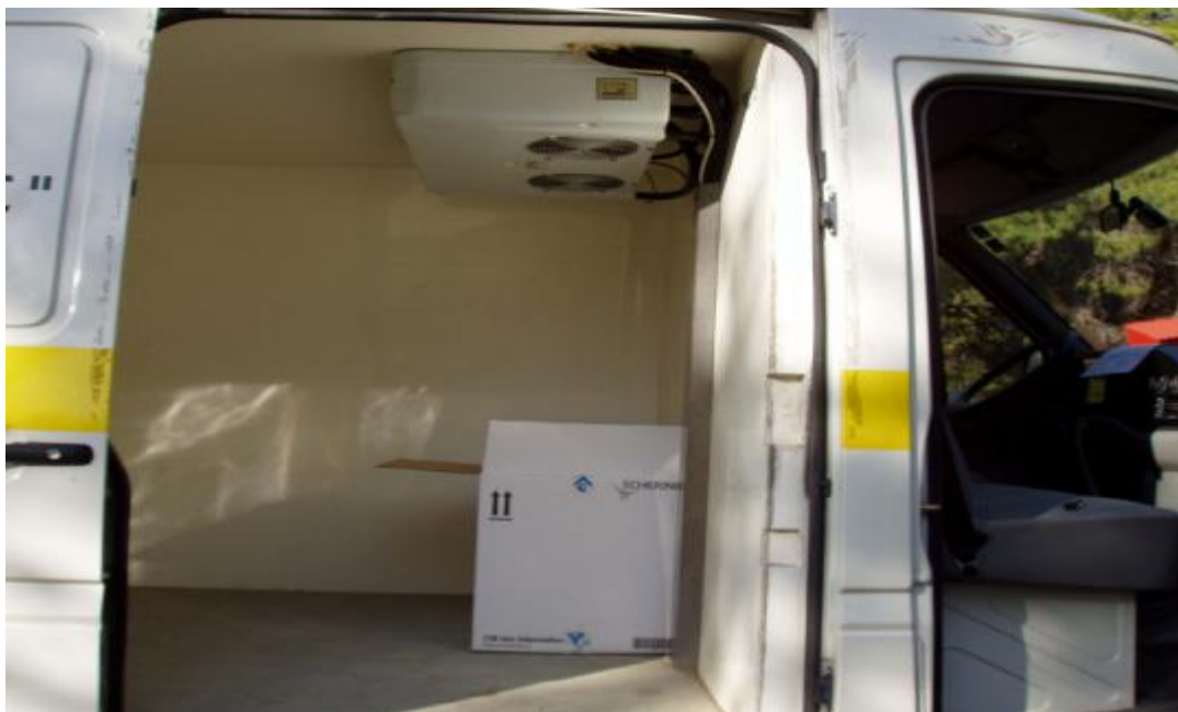
Εικόνα 12: Εξοπλισμός ψύξης στα φορτηγά οχήματα
