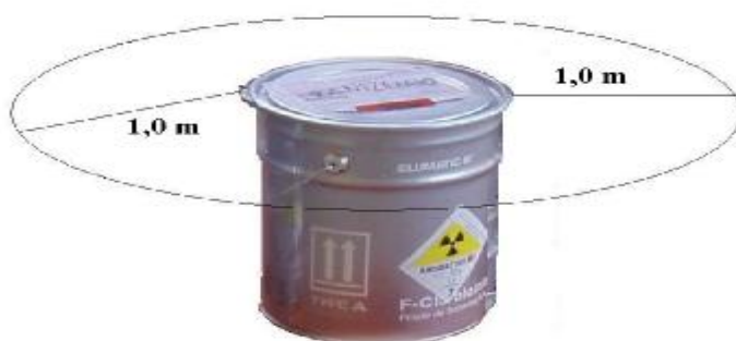
Εικόνα 8: Επίδραση σε απόσταση 1 m και καθορισμός Δείκτη Μεταφοράς
