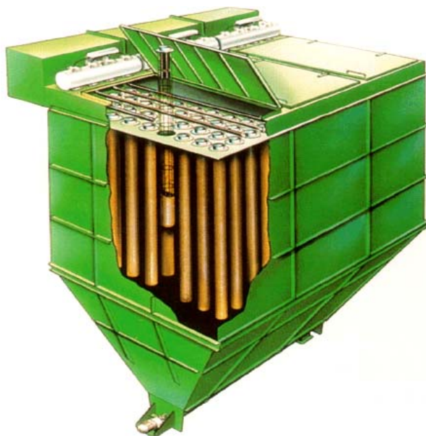
Σχήμα 3.8: Τυπικό διάγραμμα σακόφιλτρου [IPPC, 2003a]
