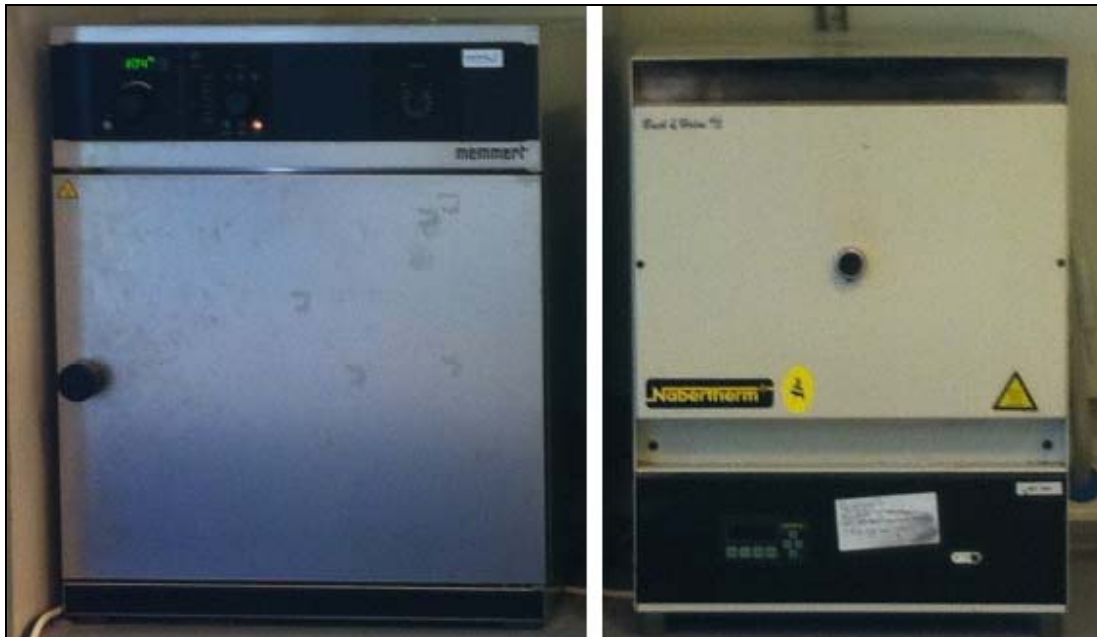
Σχήμα 5.3. Φούρνοι 105°C και 550°C για τον προσδιορισμό των ολικών και πτητικών αιωρούμενων στερεών
