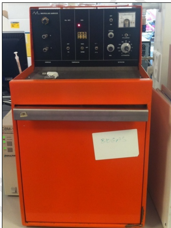
Σχήμα 5.6. GC-biogas TCD για το προσδιορισμό της σύστασης του παραγόμενου βιοαερίου
