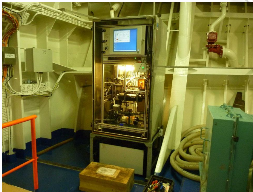
Εικόνα 1.12: Το σύστημα Ferry-Box ( http://www.myocean.eu/web/41-in-situ.php )
