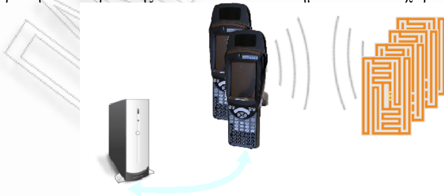
Σχήμα 1. Τυπικό σύστημα RFID που αποτελείται από το back-end υπολογιστικό σύστημα, αναγνώστες και ετικέτες
