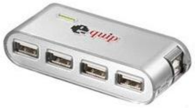
Εικόνα 3.11. Ένα τυπικό hub στο οποίο υπάρχει δυνατότητα σύνδεσης 4 συσκευών USB.
