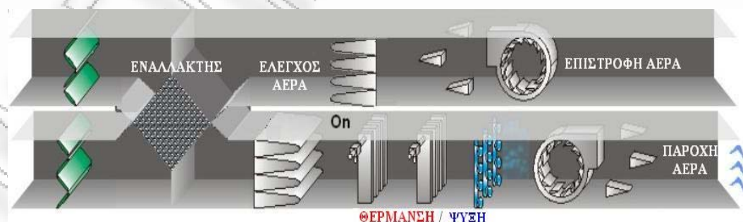
Σχήμα 5.11: Λειτουργία Κεντρικής Κλιματιστικής Μονάδας
