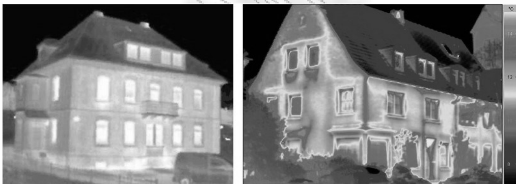
Σχήμα 5.1: Προβολή απωλειών θερμότητας με χρήση θερμικής κάμερας 30
