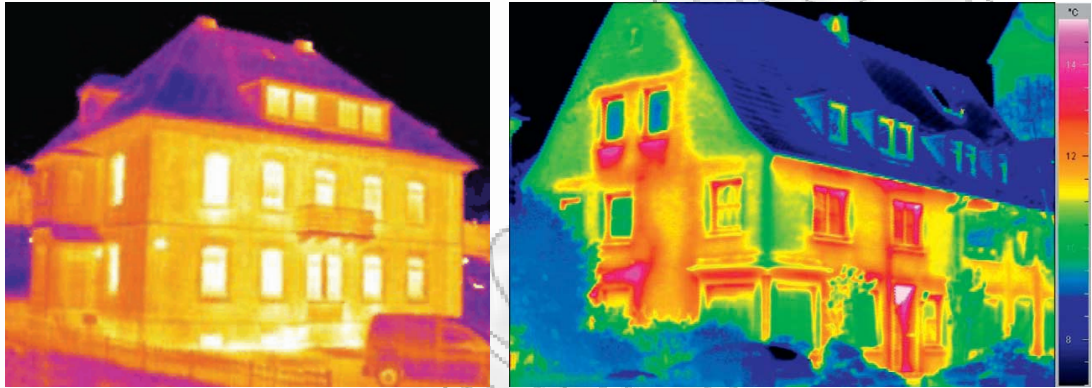
Σχήμα 5.1: Προβολή απωλειών θερμότητας με χρήση θερμικής κάμερας 55
