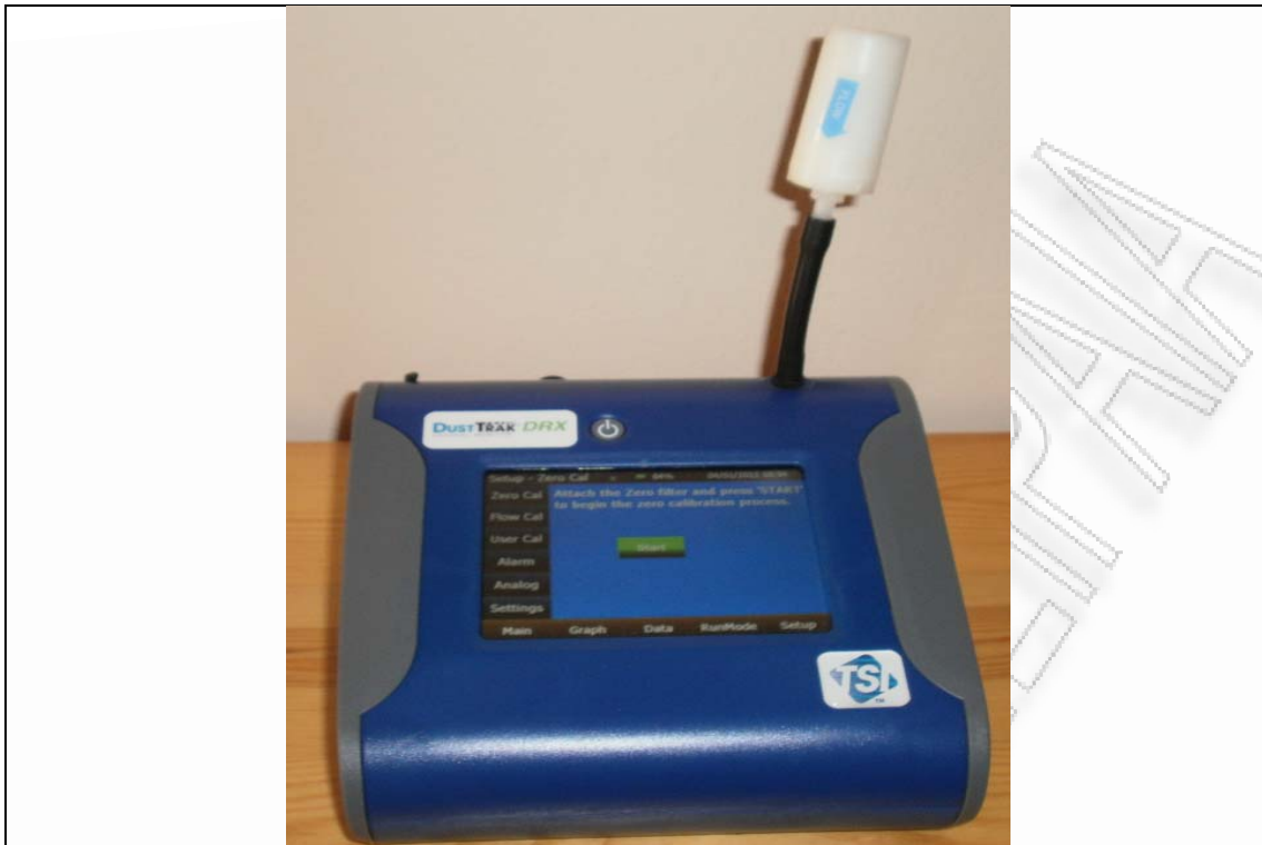
Εικόνα 5: Το όργανο μέτρησης DustTrak με το zero filter για την επίτευξη της βαθμονόμησης .
