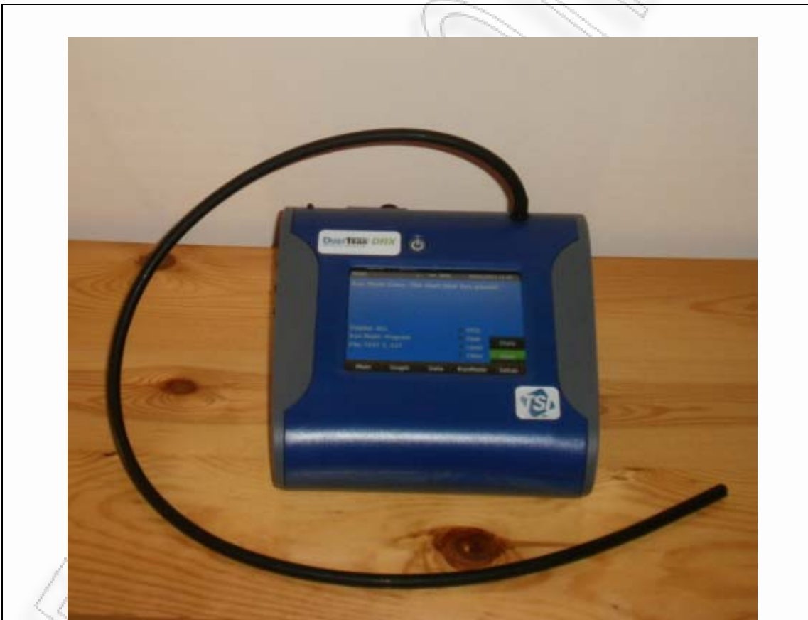
Εικόνα 4: Το όργανο μέτρησης DustTrak με τον σωλήνα μέσω του οποίου έγινε η είσοδος των σωματιδίων
