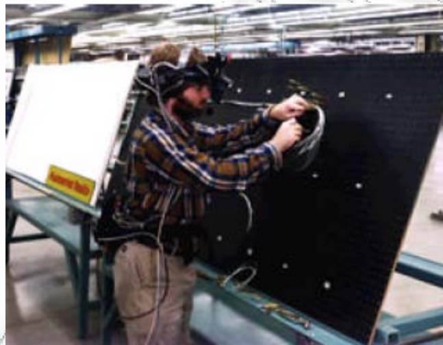
Εικόνα 7: Σύστημα ενισχυμένης πραγματικότητας μέσω HMD της Boeing
