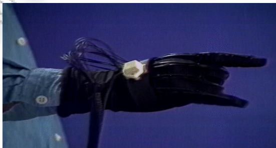
Εικόνα 3: Ηλεκτρονικό γάντι ή γάντι δεδομένων
