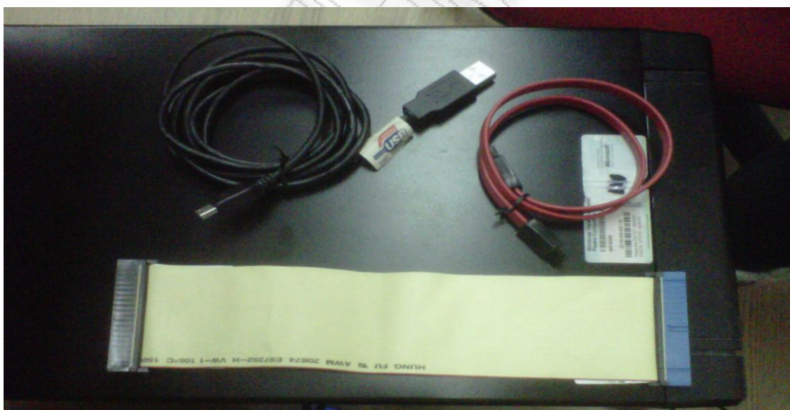
Εικόνα 28 Καλώδια USB, SATA και IDE
