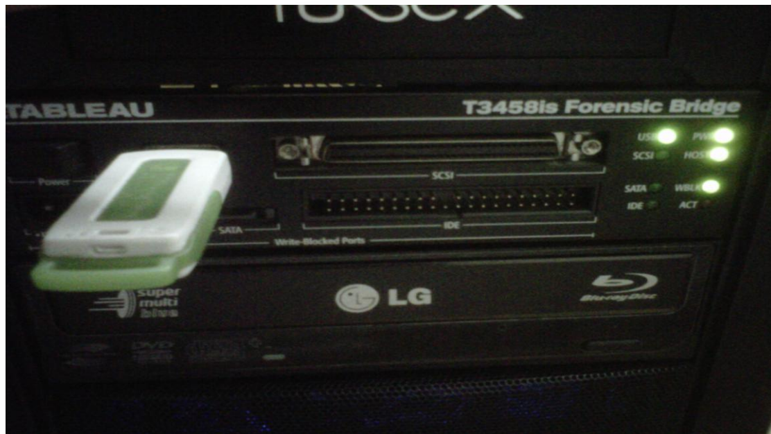
Εικόνα 29 Ενδείξεις του Tableau T3458is Forensic Bridge
