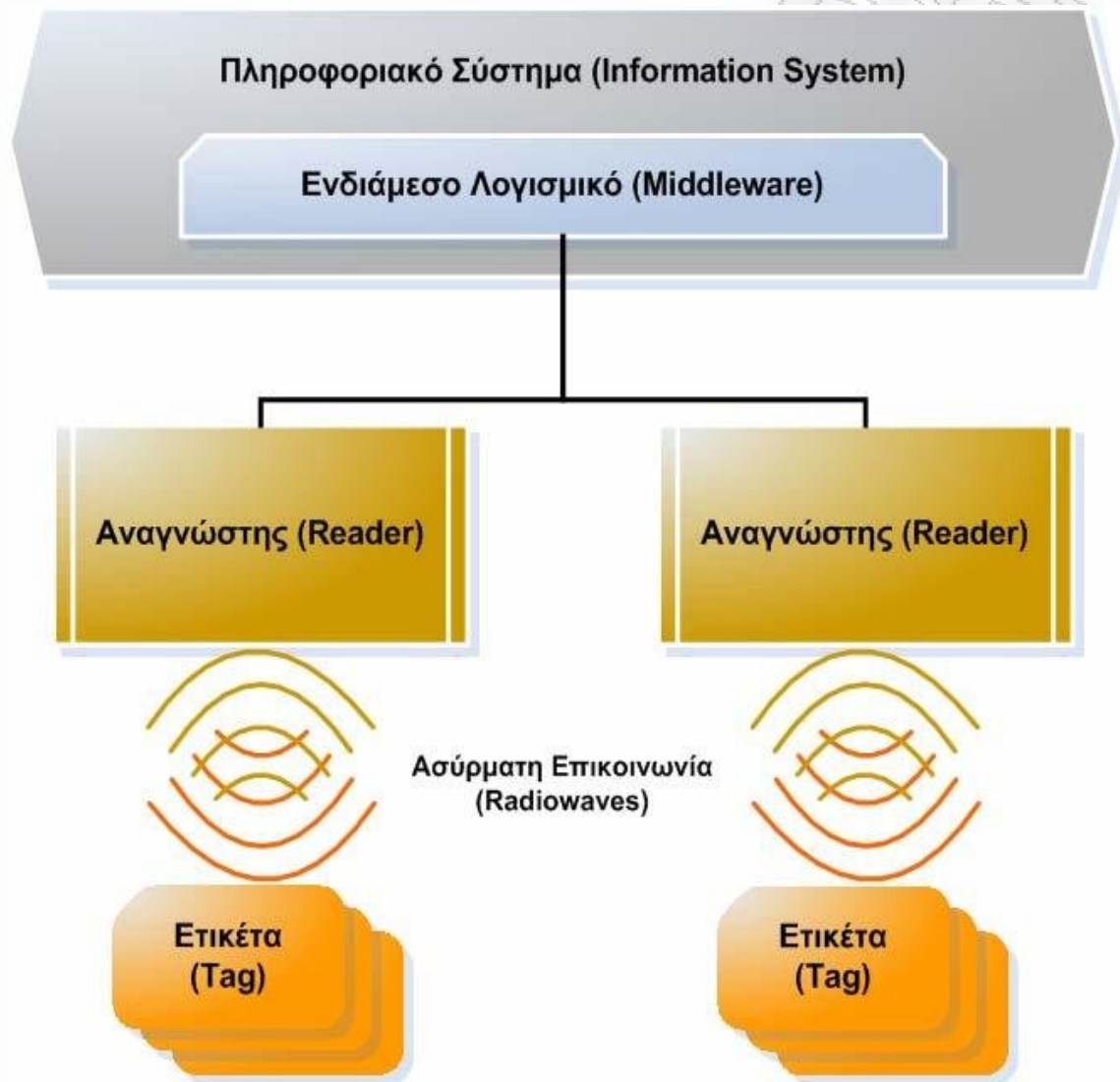
Σχήμα 11 : Αρχιτεκτονική συστήματος RFID
