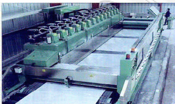
Σχήμα 4.18: Μηχανή στίλβωσης πλακών με μία σειρά κεφαλών.
