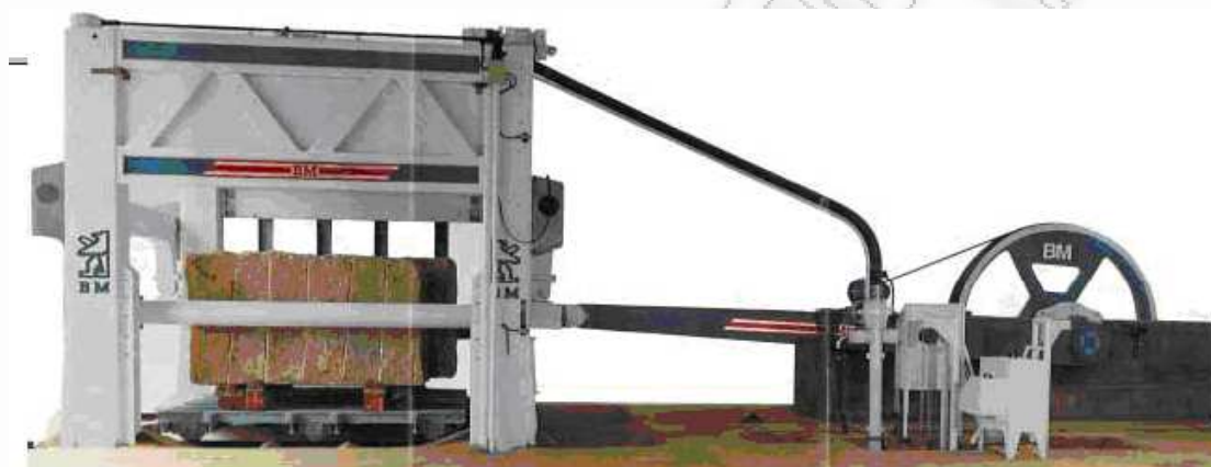
Σχήμα 4.5: Τελάρο κοπής μπλοκ γρανίτη.
