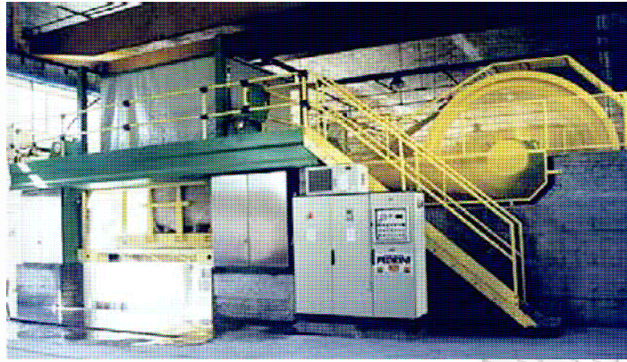
Σχήμα 4.4: Πλαίσιο πολλαπλών λεπίδων διαμαντιών.
