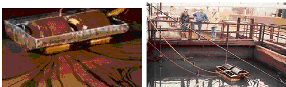
Εικόνα 8.9: Ο τρόπος λειτουργίας των skimmers με ελαιόφιλα στοιχεία.
