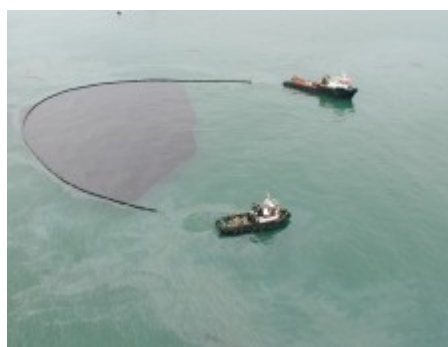
Εικόνα 8.7: Ρυμούλκηση πλωτών φραγμάτων σε μορφή J.
