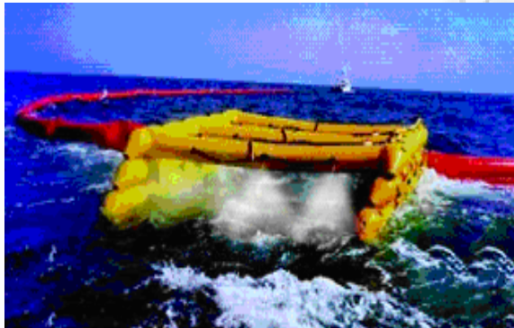
Εικόνα 8.11: Τρόπος ψεκασμού Χ.Δ.Ο. σε συνδυασμό με τη χρήση πλωτών φραγμάτων.
