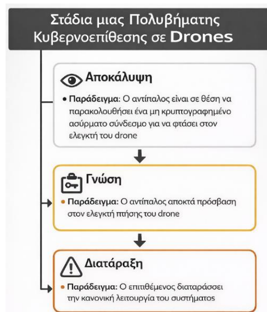
Εικόνα 4: Βήματα μιας τυπικής κυβερνοεπίθεσης πολλαπλών βημάτων σε drones.
