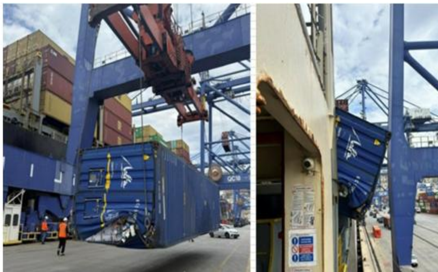
Εικόνα 2: Πτώση container στο λιμάνι, λόγω κακού πιασίματος από τον γερανό (Πηγή: Αρχείο βάσει πραγματικού περιστατικού από την επαγγελματική εμπειρία)
