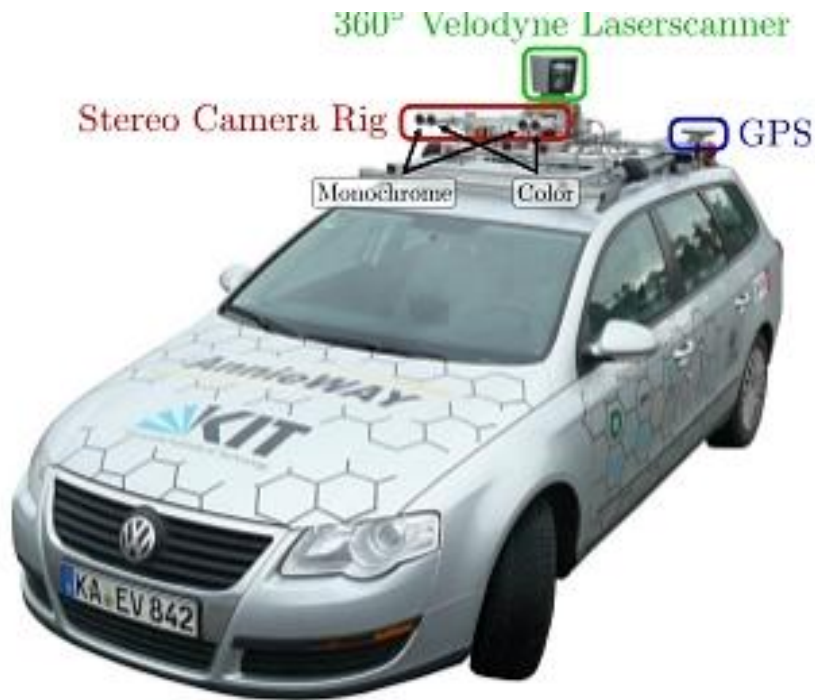
Εικόνα 41. Εξοπλισμός οχήματος συλλογής εικόνων για το KITTI dataset
