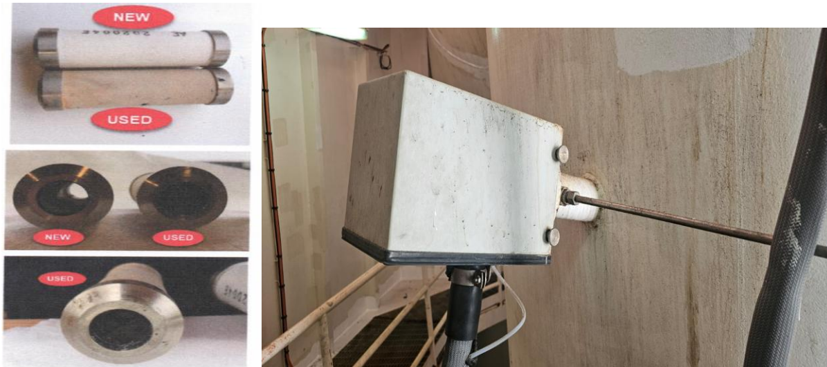
Εικόνα 19. Probe – filter συλλογής καυσαερίων
