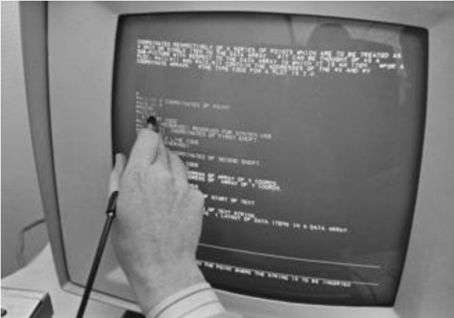
Εικόνα 10: IBM 2250 Graphics Display Unit. Πηγή: By Gregory Lloyd - Own work, CC BY-SA 4.0, https://commons.wikimedia.org/w/index.php?curid=91207762
