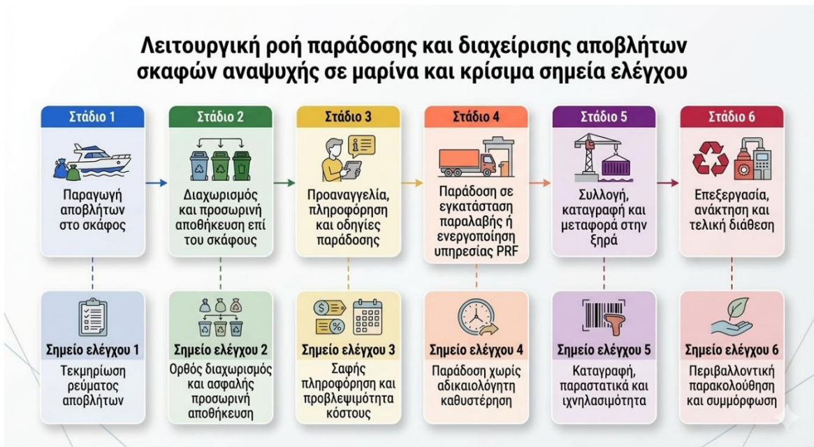
Εικόνα 2: Λειτουργική ροή παράδοσης και διαχείρισης αποβλήτων σκαφών αναψυχής σε μαρίνα και κρίσιμα σημεία ελέγχου
