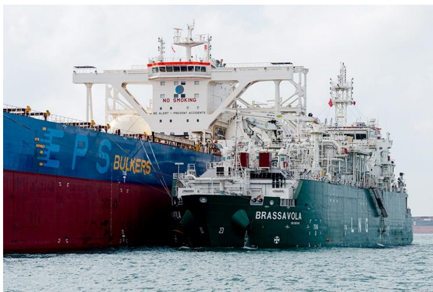
Εικόνα 2: Το LNG bunkering vessel "Brassavola" κατά την πρώτη υπηρεσία τροφοδοσίας LNG σε bulk carrier στο λιμάνι της Σιγκαπούρης, Φεβρουάριος 2024. Πηγή: Mitsui O.S.K. Lines (MOL), https://www.mol.co.jp/en/pr/2024/24025.html
