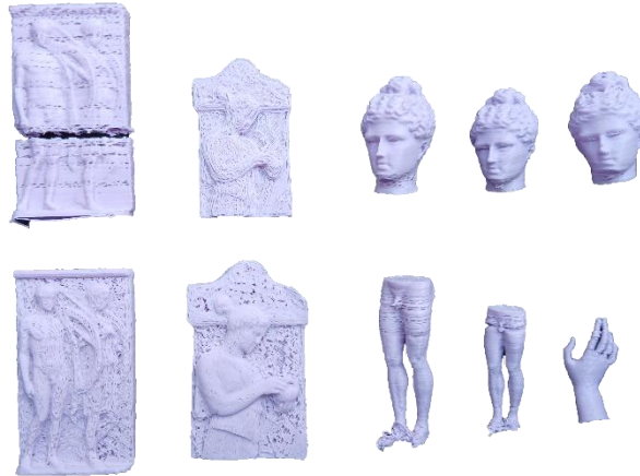
Εικόνα 30: Πρώτη δοκιμαστική εκτύπωση για τον έλεγχο της ορθότητας του πλέγματος (watertight mesh) και την επαλήθευση της δυνατότητας τρισδιάστατης παραγωγής του. (Φωτογραφία της γράφουσας). © ΥΠΠΟ / ΕΦΑΠΝ / ΟΔΑΠ
