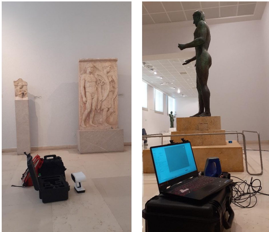
Εικόνα 23: Στιγμιότυπα από την επιτόπια τρισδιάστατη σάρωση των εκθεμάτων με τη χρήση των σαρωτών Artec Leo και Spider. (Φωτογραφίες της γράφουσας). © ΥΠΠΟ / ΕΦΑΠΝ / ΟΔΑΠ
