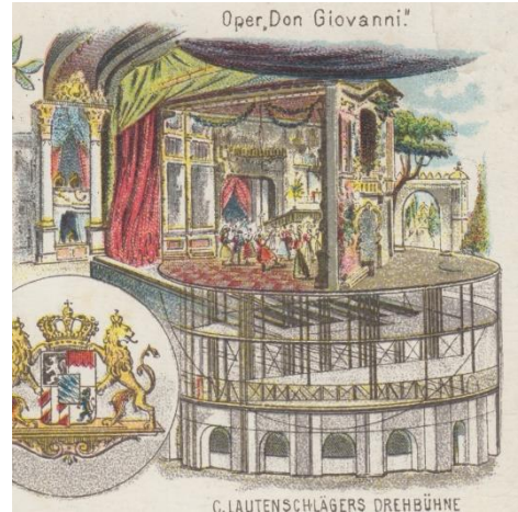
Εικόνα 12 Η περιστρεφόμενη σκηνή του Lautenschläger στο Μόναχο, με το σκηνικό για τον Don Giovanni του Mozart. Μηχανισμός που αναβάθμισε την ευελιξία και τη δραματικότητα στις θεατρικές παραγωγές.
