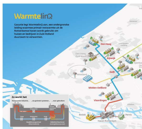
Εικόνα 11: Σχέδιο νέου Αγωγού θερμότητας WarmtelinQ
